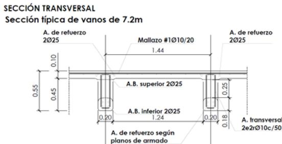
Figura 12: Detalle de armado de nervio para forjado de Edificio en Elche
