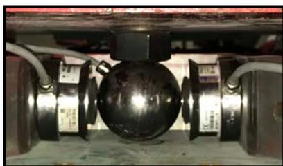
Figura 7: Célula de carga HBM RTN-100 alrededor de la esfera de acero
